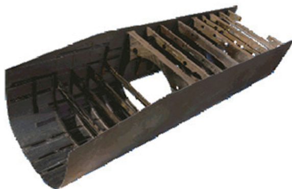
图2 RTM成型AH-64D直升机中机身结构
